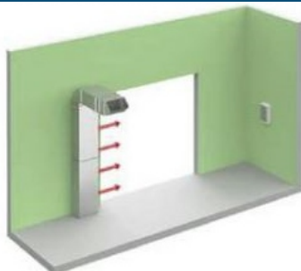
Вертикальное расположение 2-х завес с отводом нагнетающего блока вбок
